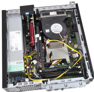
9. プラスドライバーを使って、コンピューターの背面から電源を固定しているネジを取り外します。
