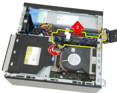
6. 固定タブがカードのくぼみから外れるまでリリースレバーを PCIe x4 カード(もしあれば)からそっと引っ張り出します。次にカードをコネクタから外して、コンピューターから取り外します。
