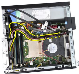
6. システム基板から入力/出力基板/FlyWire ケーブルを外します。
