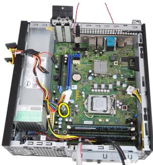
12. システム基板をコンピューターの前方向に向けてスライドします。
