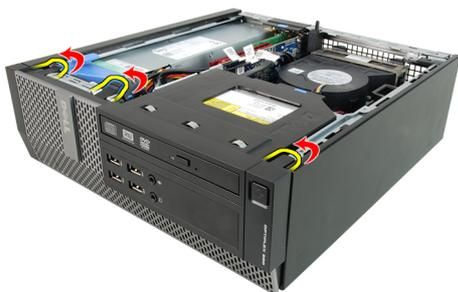
4. ベゼルの逆に傾けて、ベゼルのもう一方の縁にあるフックをシャーシから外します。
