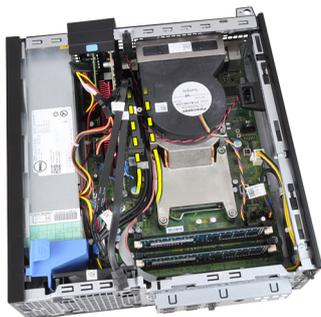
7. プラスドライバーを使って、ヒートシンクとファンアセンブリをシステム基板に固定している拘束ネジを緩めます(1>2>3>4の順に)。
