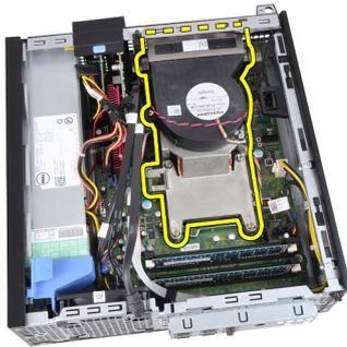
9. リリースレバーを押し下げて、次に外側に向けて動かして固定フックから外します。
