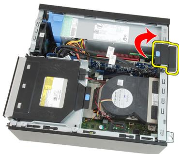
5. 固定タブがカードのくぼみから外れるまでリリースレバーを PCIe x16 カードからそっと引っ張り出します。次にカードをコネクタから外して、コンピューターから取り外します。
