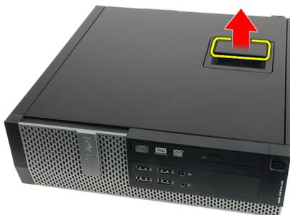
3. カバーを 45 度の角度で引き上げ、コンピューターから取り外します。
