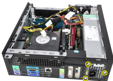
10. 電源の横の青いリリースタブを押し込み、電源をコンピューターの前部の方へスライドさせます。
