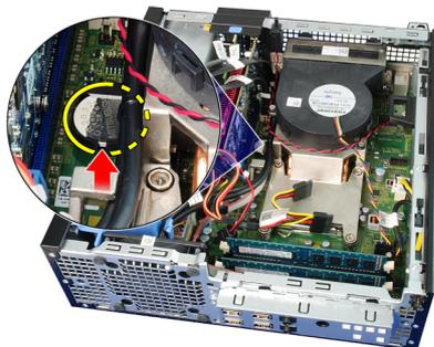
5. コイン型電池をコンピューターから取り出し、電池を適切に処分します。
