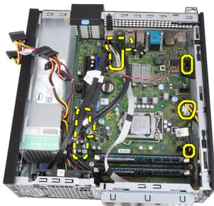
9. 拡張カードラッチを持ち上げて解除し、システム基板を固定しているネジにアクセスできるようにします。
