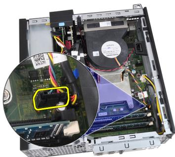
6. 出力/入力基板/FlyWire ケーブルをヒートシンク上の配線から外します。
