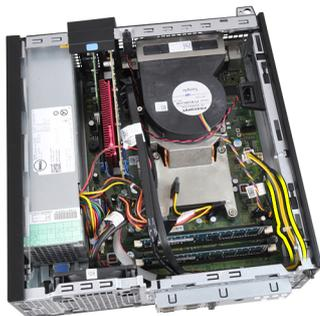
8. 24ピン電源ケーブルをシステム基板から外します。
