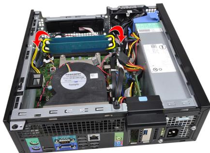
6. システム基板上のコネクタからメモリモジュールを引き上げます。
