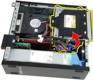
7. データケーブル(1)と電源ケーブル(2)をハードドライブの背面から取り外します。
